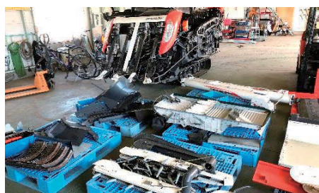
コンバイン分解清掃状況 (異品種混入防止対策)
